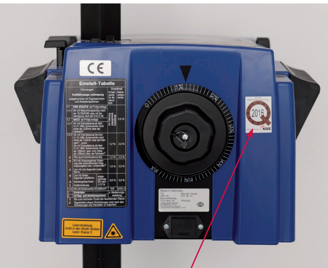
Prüfgerät mit sichtbar aufgebrachter gültiger Kalibrierungsmarke
